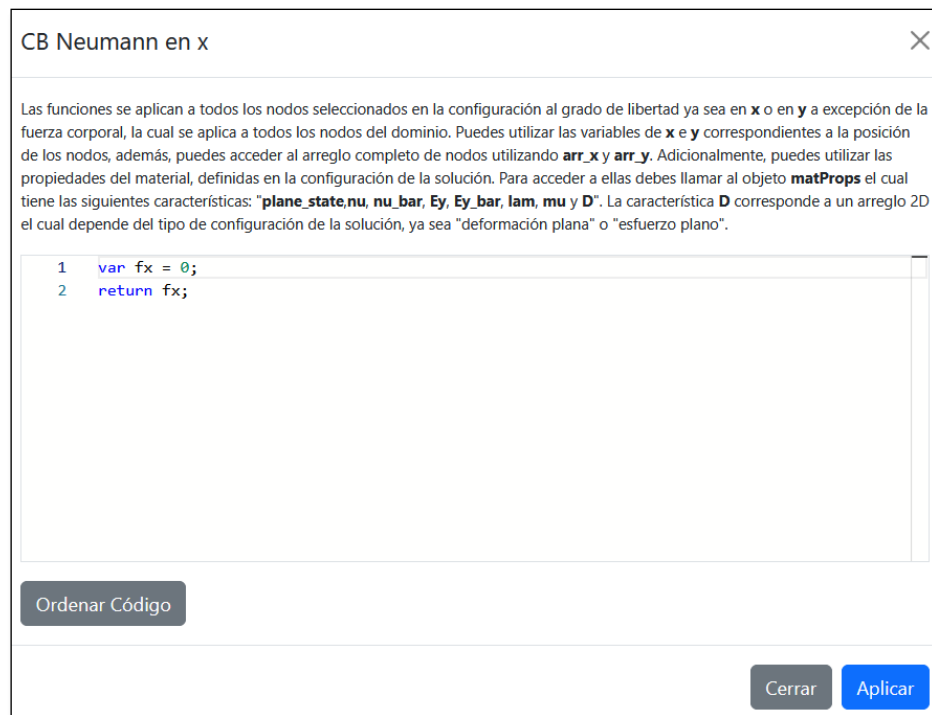
Figura 37. Configuración de funciones de condiciones de contorno
