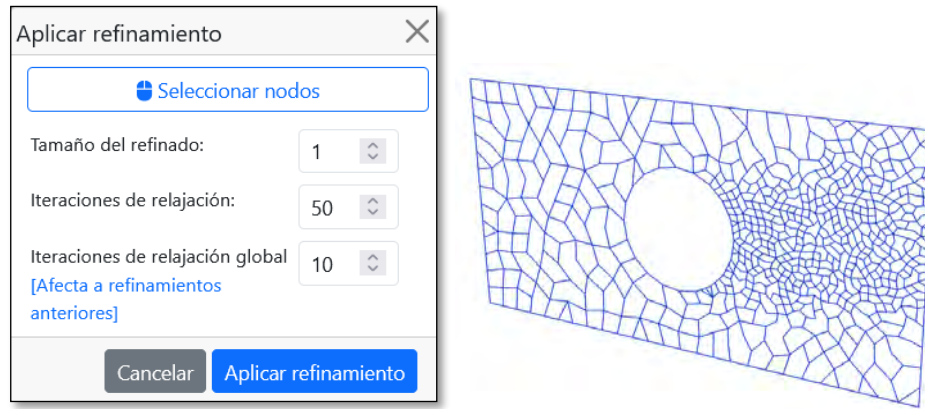
Figura 27. Formulario de refinamiento de malla y resultado del refinamiento
